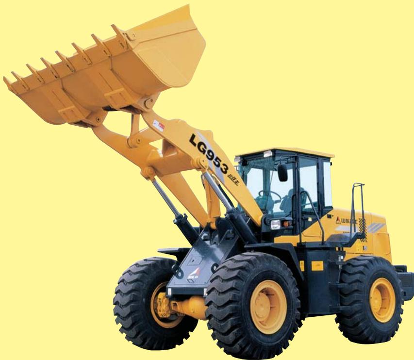
Погрузчик LG 953 представляет 3 поколение погрузчиков, произведенных компанией Shandong Lingong. Длинная колесная платформа, высокая эффективность в работе, низкое потребление топлива, большая мощность и небольшой радиус поворота позволяют грузить и перевозить большие предметы и камни. Погрузчик обладает рядом отличительных характеристик:
